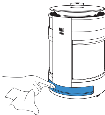
清理缓冲防撞板和充电座信号识别传感器
