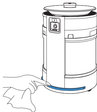
清理缓冲防撞板和充电座信号识别传感器
